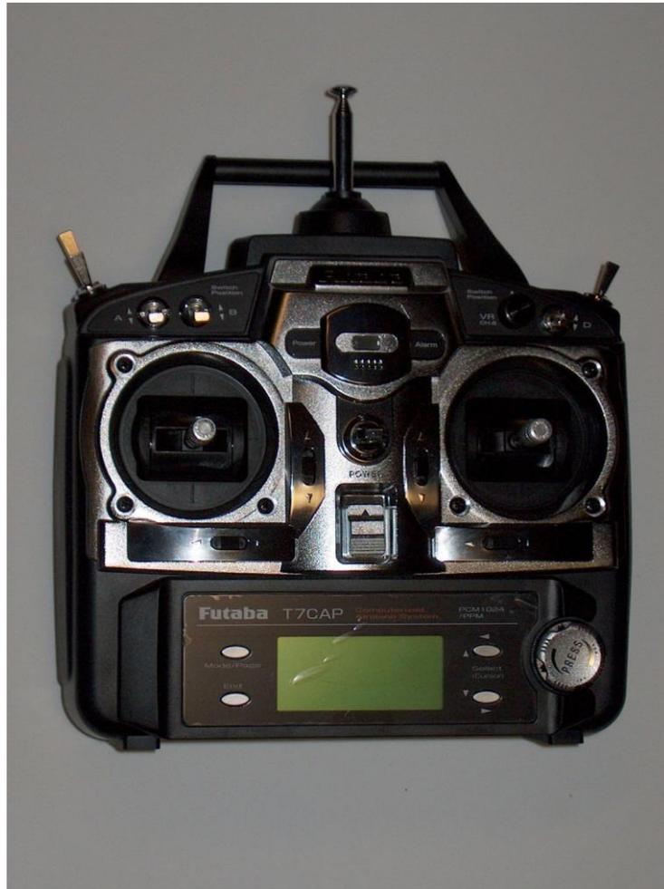
图 1.1 2.4 GHz PPM 遥控器
